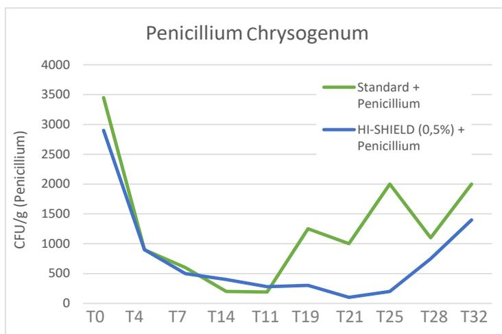
Effet anti-moisissure testé pendant la durée de vie du produit : après 14 jours, le développement et la croissance des moisissures restent en dessous du standard avec HI-SHIELD, malgré les conditions d'essais critiques.
